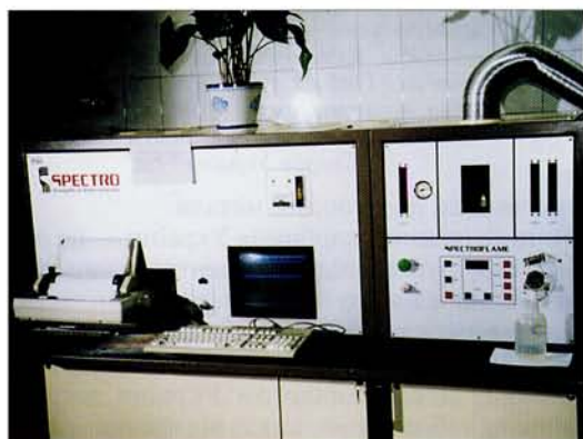
Прилад "Spectroflame" для високотемпературної експертизи хімічного складу банківських металів атомно-емісійним методом з індукційно зв'язаною плазмою.
