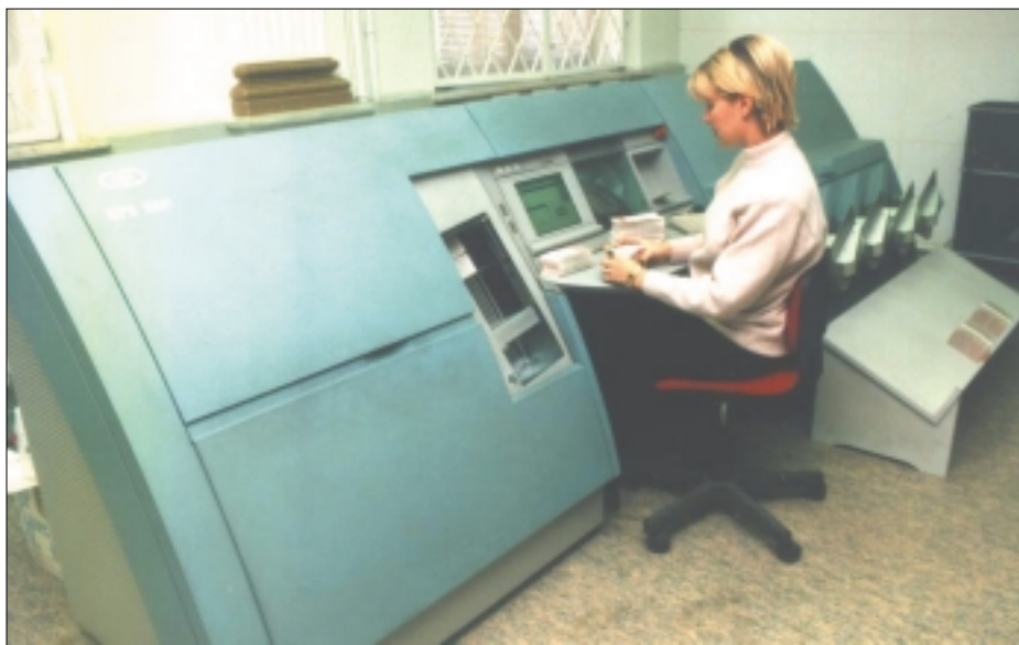
На швидкісній автоматизованій системі обробки банкнот моделі BPS-3000 виробництва фірми "Giezeke & Devrient", встановленій в управлінні НБУ по Києву і Київській області, може оброблятися від 400 до 500 тисяч банкнот за робочу зміну.
