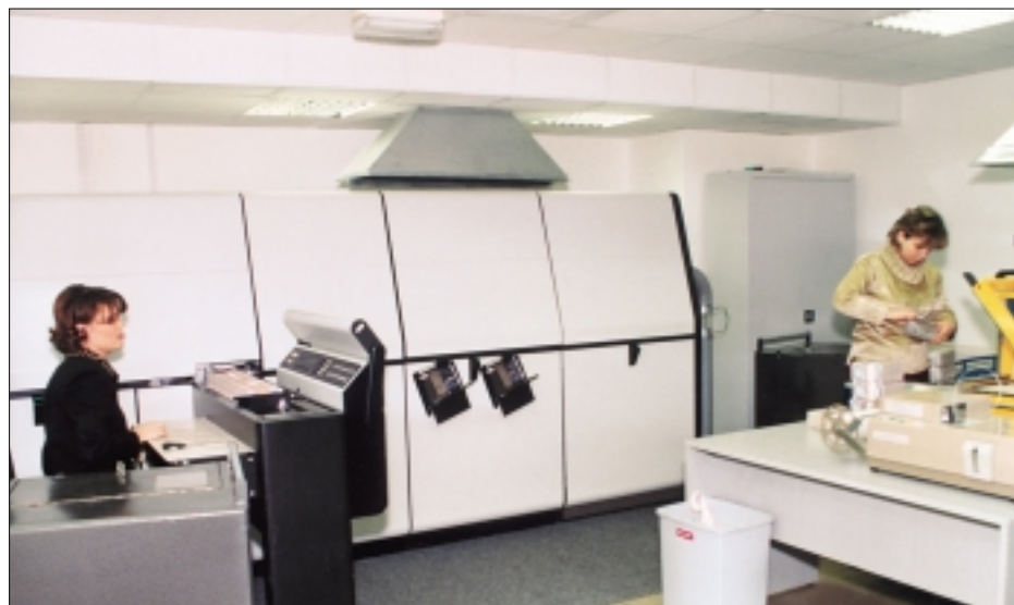
Автоматизована система обробки банкнот BPS-1000 виробництва фірми "Giesecke & Devrient", встановлена у Харківському територіальному управлінні НБУ, допомагає перераховувати та сортувати великі обсяги готівки.
