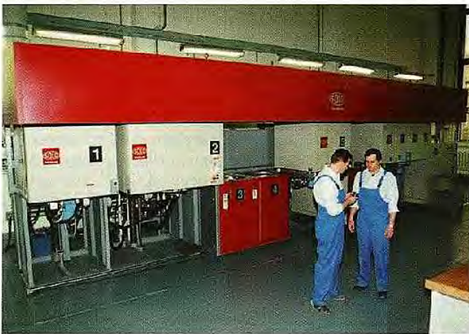
На машинах фірми "Solo" матричний інструмент проходить термічну обробку.
