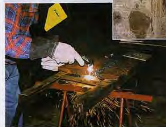
Швидкість розрізання двосантиметрової сталевий плити плазмовим різак — 2 сантиметри за секунду.
