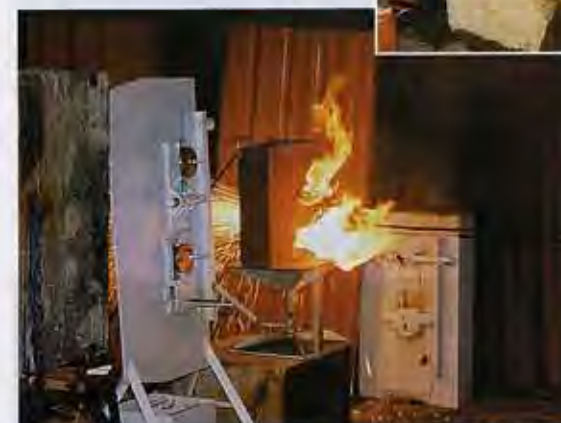
Атака елемента модульного залізобетонного сховища кисневим списом.
